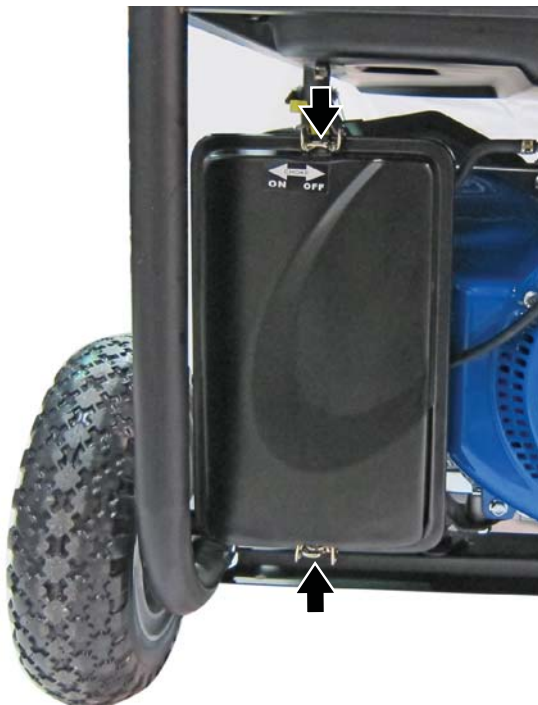
Figura 35 – Instalación de la Tapa del Filtro de Aire
