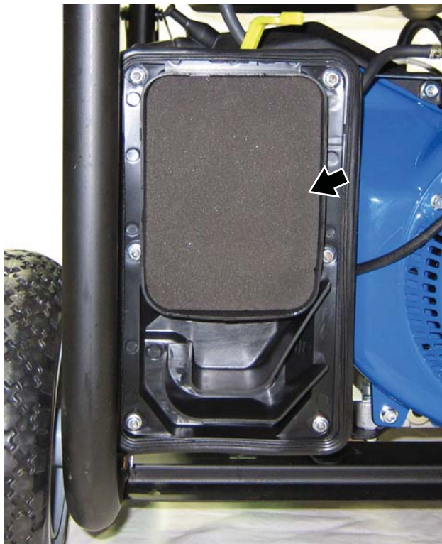
Figura 32 – Remoción del Elemento Fino del Filtro de Aire
